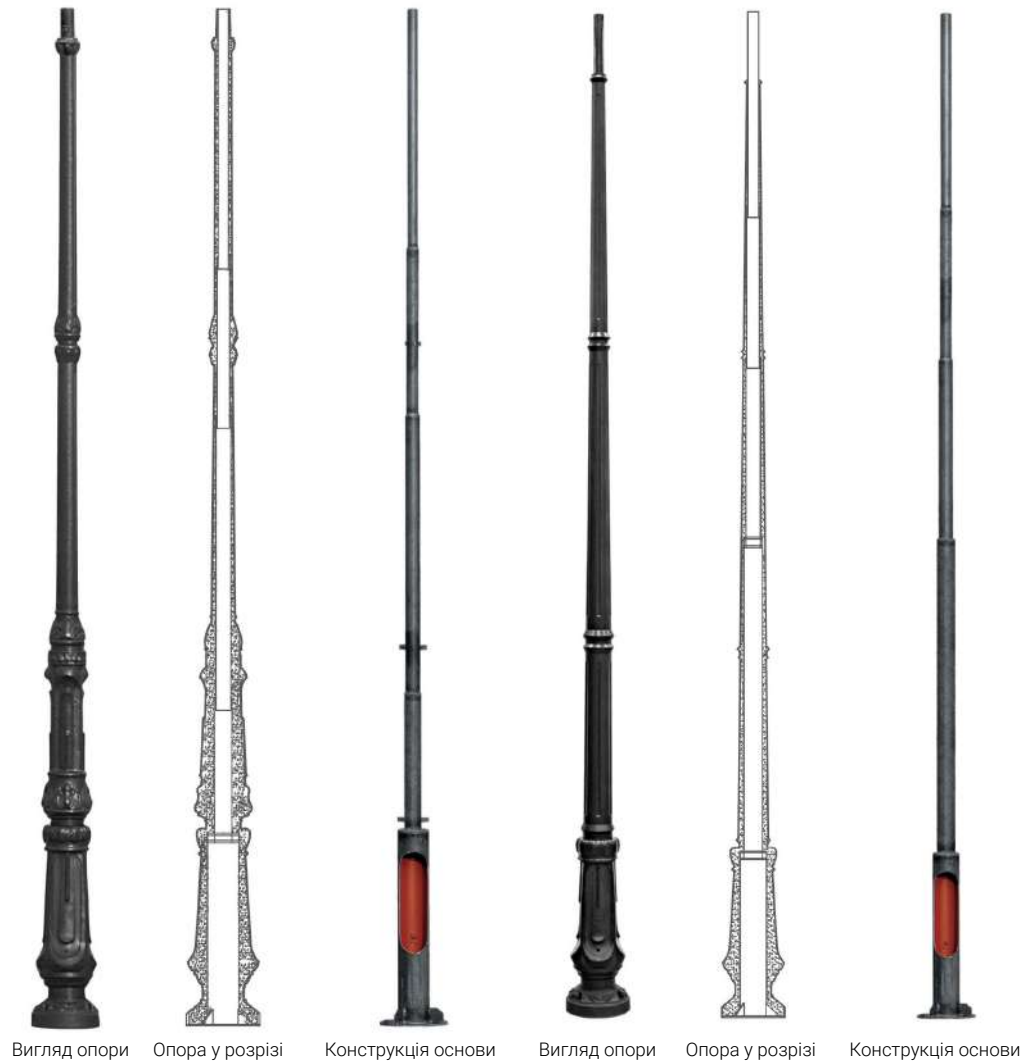
Приклад конструкції опори S-40W
