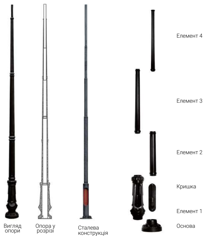
Приклад конструкції опори типу SM-1W/E
