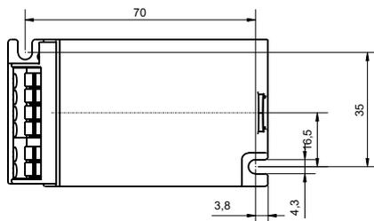
Исполнение с фиксирующим болтом:
