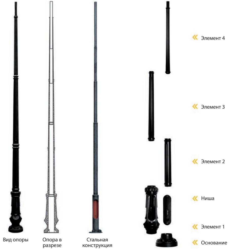
Схема конструкции опоры типа SM-1W/E
